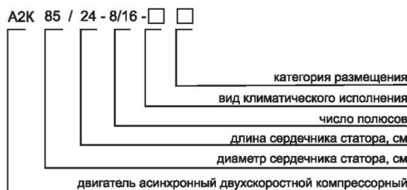
Электродвигатели асинхронные двухскоростные с короткозамкнутым ротором А2К предназначены для привода оппозитных компрессоров типа 2ВМ4-24/9.
