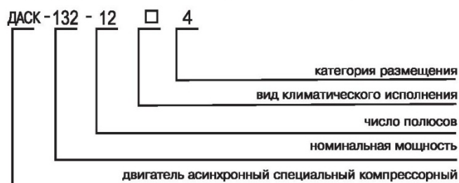
Структура условного обозначения двигателей типа ДАСК-132
