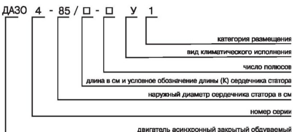
Структура условного обозначения типа двигателей серии ДАЗО4 напряжением 10 кВ
